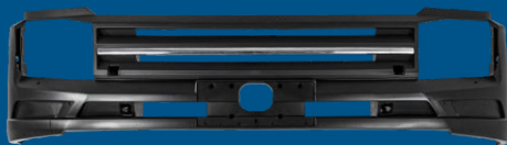
Cód. BL: W50092 Cód. Original: 23B807071A Descrição: P/ Choque VW Delivery (9-170) Material: Plástico (Termoformado) Cor: Branco (Natural)
